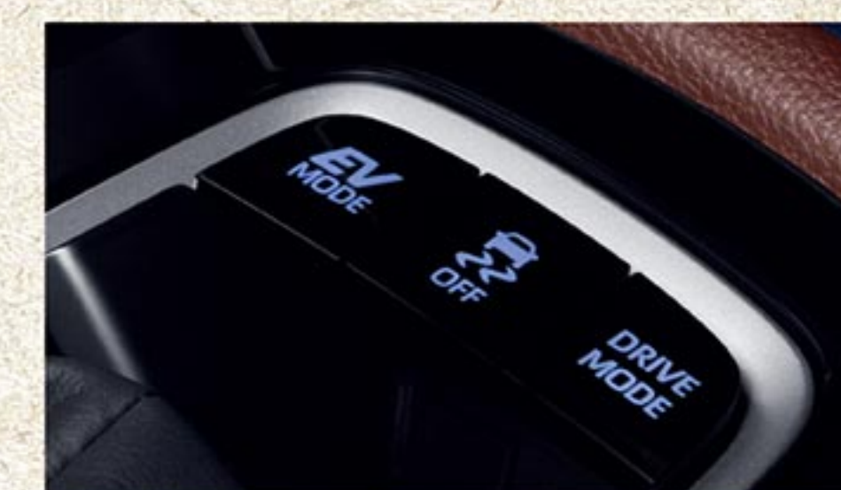
EV MODE ใช้กำลังจากมอเตอร์ไฟฟ้าเพื่อการเดินทางที่เงียบสนิม SPORT MODE เพิ่มสมรรถนะในการขับขี่ และตอบสนองอัตราเร่งได้ดียิ่งขึ้น ECO MODE ช่วยลดการใช้พลังงานที่สิ้นเปลือง เพื่อการใช้พลังงานอย่างมีประสิทธิภาพ
