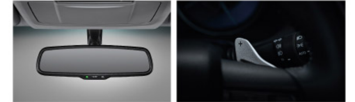
EC Mirror กระจกมองหลังลดแสงสะท้อนอัตโนมัติ จับที่ปลอดภัยมากขึ้นตอนกลางคืน Paddle Shift ระบบควบคุมการเปลี่ยนเกียร์ที่พวงมาลัย เพิ่มความสะดวกในการขับขี่
